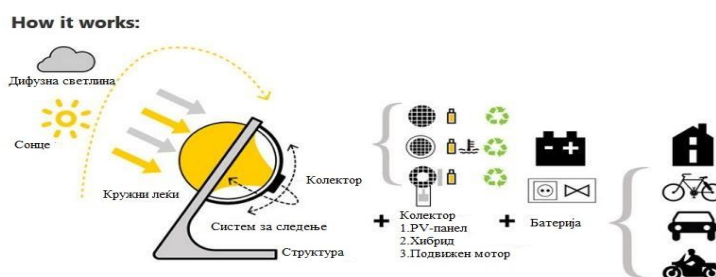
Сл. 2 – Принцип на работа на сферен генератор на светлина и негова употреба
