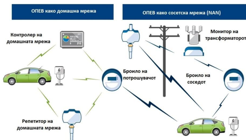
Слика 2. Шематски приказ на опциите за поврзување на ОПЕВ
