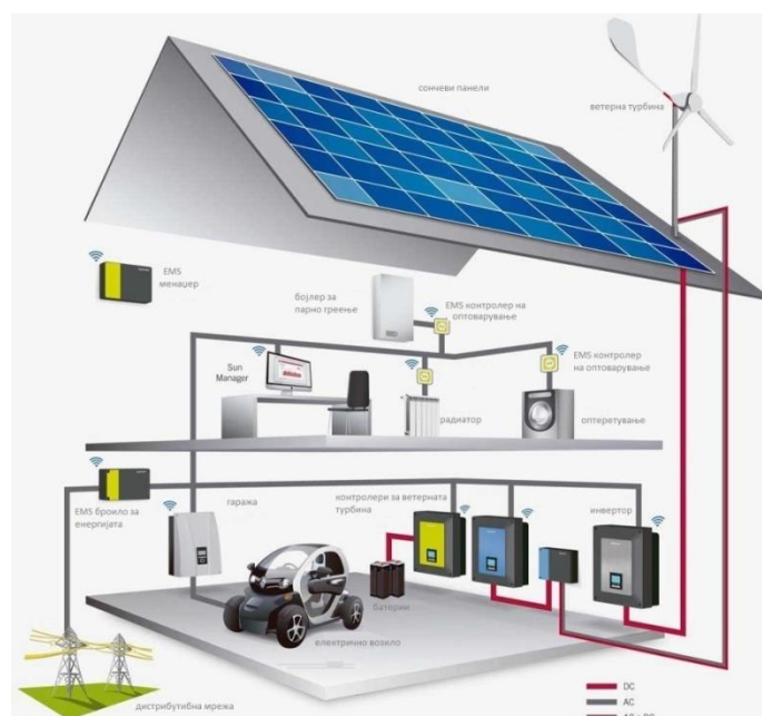
Слика 1. Шематски приказ на електричното поврзување на уредите во една паметна куќа, [intdesigbhome.com/smart-house-green-technology]
