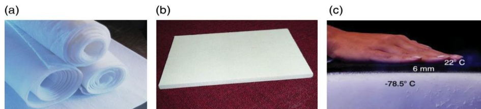
Слика 6. а) Аерогел прекривка б) Аерогел панел с) Супер-изолациона аерогел прекривка
