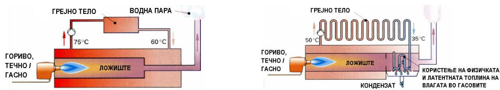
Слика 2. Искористување на долната топлинска моќ на горивото [5] Слика 3. Искористување на горната топлинска моќ на горивото [6]
