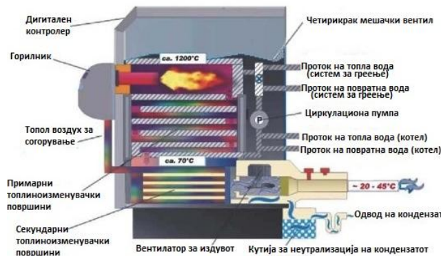
Слика 5. Конструктивен изглед на современ кондензациски котел со составните компоненти
