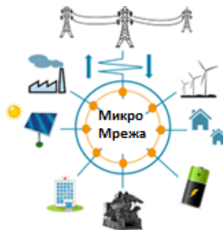
Слика 1 Елементи на микро мрежа
