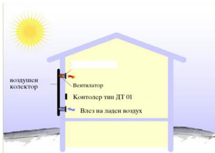
СЛИКА 2. Фасадно инсталиран воздушен колектор
