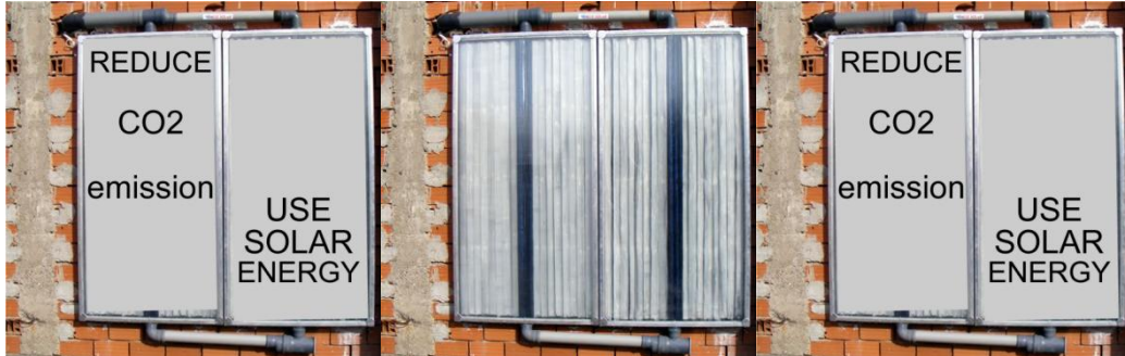
СЛИКА 5. ПОЛОЖБА 1 И 2 НА ВОЗДУШЕН КОЛЕКТОР(ПРВА СЕРИЈА) СО РОТИРАЧКИ КЕЛИИ
