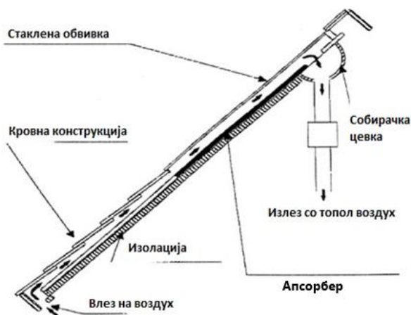
СЛИКА 3. Кровно интегриран воздушен колектор
