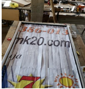
Слика 7. ПРОТОТИП НА ВОЗДУШЕН КОЛЕКТОР СО ТРИАГОЛНИ РОТИРАЧКИ КЕЛИИ
