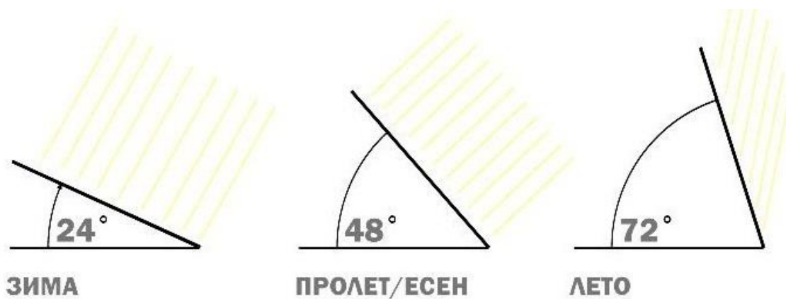
Слика 2. Агли на поставување на соларните колектори
