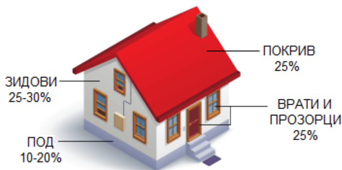
Слика 1. Просечни загуби на топлина низ преградите на една куќа [1]
