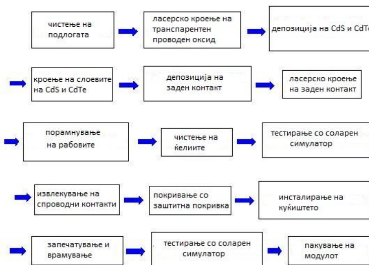
Слика 2. Процес на добивање на CdTe сончеви модули [5]
