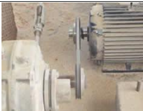
Слика 12 Паралелна непорамнетост кај ремени преносници
