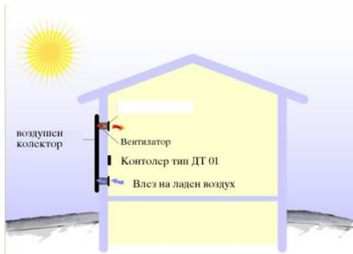
СЛИКА 2. Фасадно инсталиран воздушен колектор
