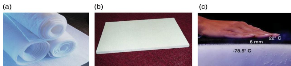
Слика 6. а) Аерогел прекривка б) Аерогел панел с) Супер-изолациона аерогел прекривка
