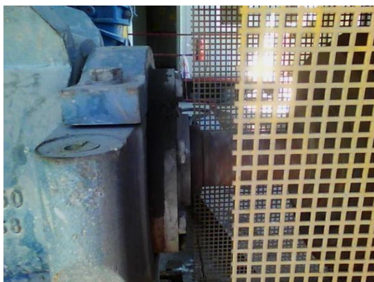
Слика 8 Загревање на лежиштето кај електромотор како резултат на лоша монтажа
