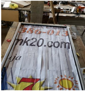
Слика 7. ПРОТОТИП НА ВОЗДУШЕН КОЛЕКТОР СО ТРИАГОЛНИ РОТИРАЧКИ ЌЕЛИИ
