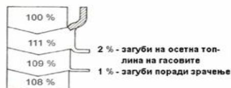
Слика 8. Споредба на ефикасноста на кондензациски котел и на нискотемпературен котел
