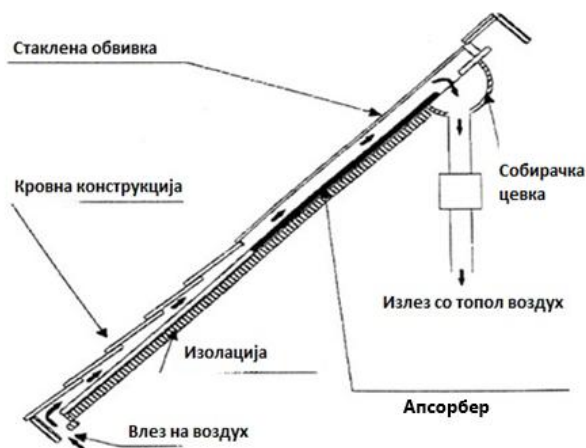
СЛИКА 3. Кровно интегриран воздушен колектор
