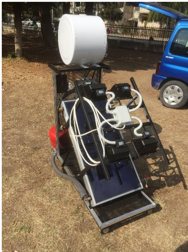
Слика 1. Едукативен пумпен сончев систем
