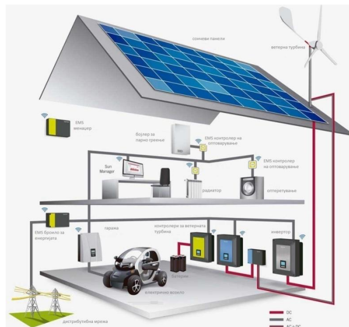
Слика 1. Шематски приказ на електричното поврзување на уредите во една паметна куќа, [intdesighome.com/smart-house-green-technology]
