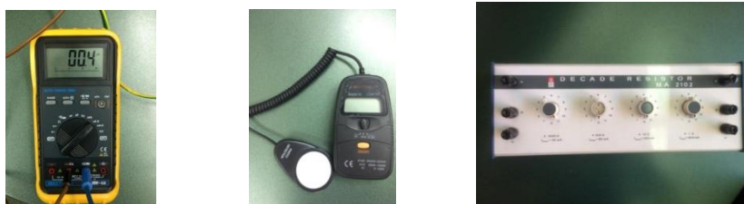
Слика 5. Приказ на мултиметарот, луксметарот и декадниот отпорник кои беа употребени при мерењата
